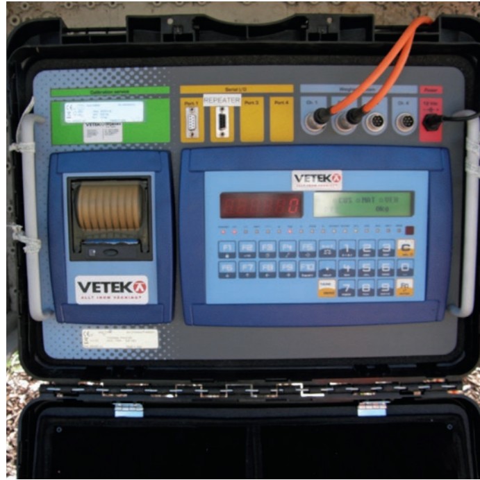
Punnitus käynnistetään ennen vaa`alle ajoa näytön funktiopainikkeesta. Punnituksen jälkeen tuloksen saa paperille.
